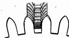
Фиг. 91. Уменьшение диаметра колеса. Пунктирные линии показывают срез.
