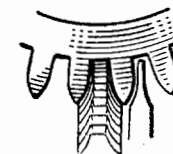
Фиг. 88. Фрезерование зубьев колеса с правильной последовательностью обработки зубьев.
