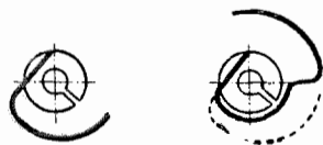
Фиг. 194. Корректировка точки заштифтовки посредством изгиба спирали.
