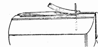
Фиг. 104. Способ зажима заводной пружины в тисках для приклепывания замка.
