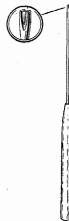
Фиг. 158. Приспособление для изгиба спирали.
