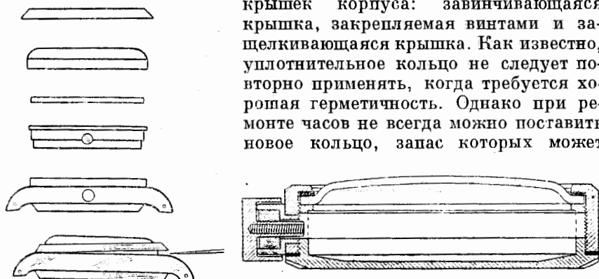
Фиг. 433. Небьющееся стекло (прижимается металлическим кольцом).
