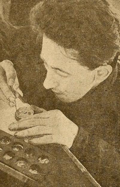
Все детали приходят в установочный цех. В установочном еще раз обмерят каждую деталь. Потом подберут детали по комплектам. Вот платина, вот мосты, вот колеса. Колеса пришли сюда золочеными и посаженными на ось. А мосты еще нужно отправить в никелировку. Комплекты мостов и платин в отдельных гнездах едут в гальванический цех.
