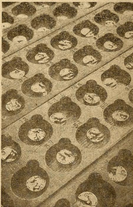
В гальваническом цеху корпуса, платины, мосты принимают ванну. Им прописано разное лечение. Корпуса купаются в растворе хромовых солей; через этот раствор пропускается электрический ток. Тогда из раствора выделяется металлический хром и тончайшим слоем отлагается на корпусах, опущенных в ванну. Теперь корпуса не боятся ржавчины и царапин: они одеты в непромокаемое пальто, они одеты в панцырь из хрома, который тверже стали.
