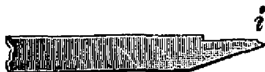
Рис. 132. Резец для сглаживания углов.
