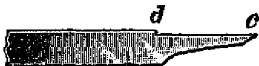
Рис. 130. Резец для проточки отверстий.
