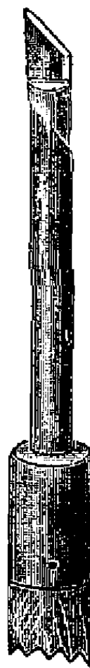
Рис. 141. Инструмент для укреп- ления ка- меней в гнез- дах.
