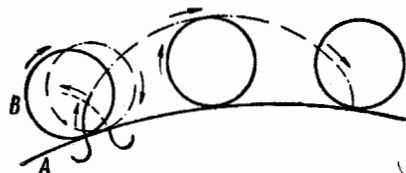
Фиг. 92. Принцип построения головки зуба.
